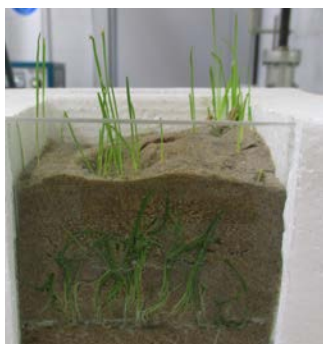
Прорастание сорняков через модифицированный песок FUS
